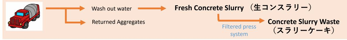
Management of Concrete Recycled Fines コンクリートリサイクル微粒分の管理
